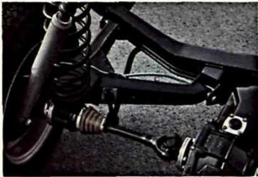
BMW Hinterachse: schräggestellte Längsschwingen
