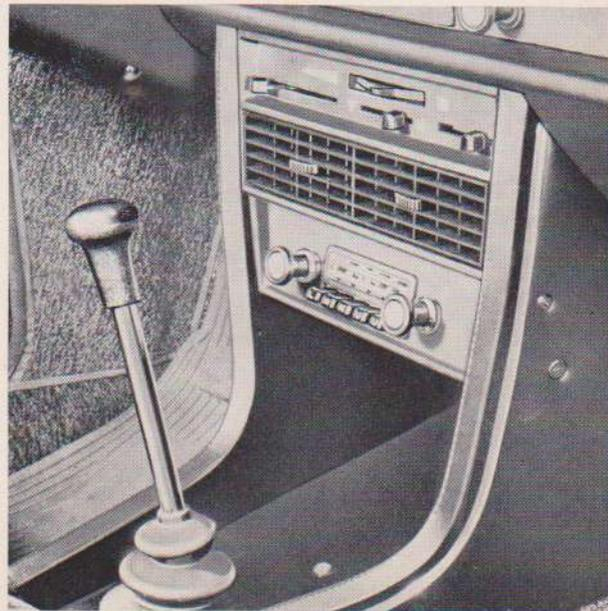
\* Radiogeräte für 12 V können auch für Fahrzeuge mit 6-V-Anlagen Verwendung finden, wenn gleichzeitig ein DC-Wandler eingebaut wird.
